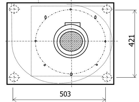
Bauform 5H (Bodenmontage - Flanschmotor)
