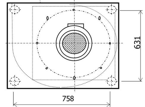
**Bauform 5H (Bodenmontage - Flanschmotor)**
