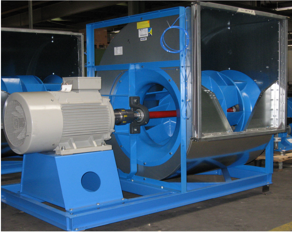
zweiseitig saugende Radialventilatoren
